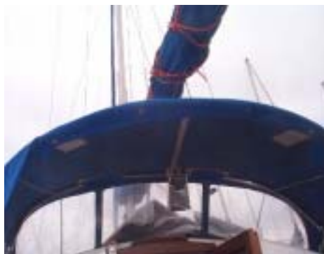
写真では見づらいが、4箇所ヒネリ金具付けて補強
