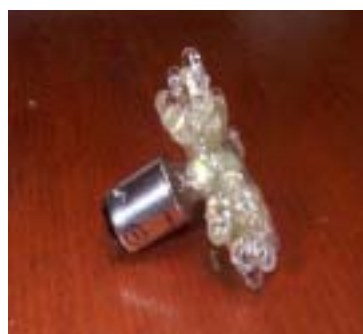
マストトップ用LED (高輝度LED24ヶ使用)
