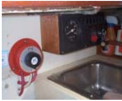
新たに付けた回転式メインスイッチとタコメーター
